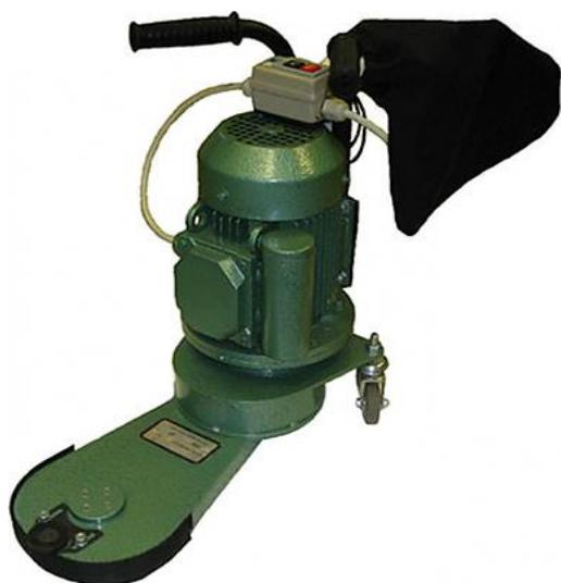
Шлифовальная машина СО 337-01, с шириной шлифования 150 мм, используется для шлифования паркетных и других деревянных полов, лестниц, участков пола вблизи стен, в углах, под радиаторами отопления и других труднодоступных мест. Машина отличается легкостью, вес составляет всего 24 кг. Также оборудование характеризуется высокой всасывающей способностью, высоким уровнем безопасности.
