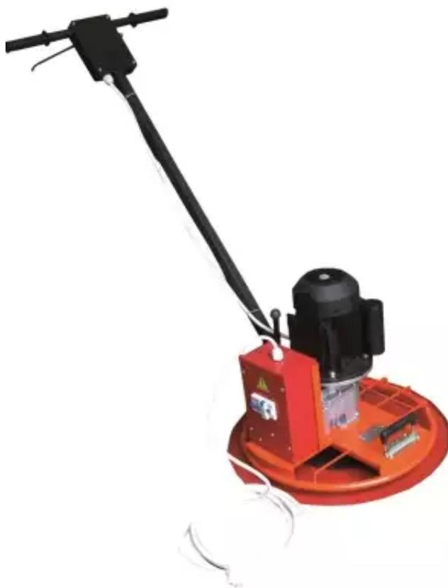
**Описание:** Машины затирочные СО-335А с трехфазным приводом 380 В, и СО-335.1А с однофазным приводом 220 В предназначены для заглаживания бетонных поверхностей малой площади и в труднодоступных местах, а также, для затирки цементно-песчаных и гипсовых стяжек под укладку полов из различных покрытий в промышленном, гражданском и жилищном строительстве. (Лопастей не предусмотрено конструкцией).
