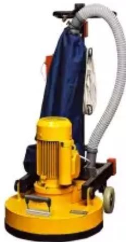
**Описание:** Машина предназначена для тонкой шлифовки паркета, в том числе и художественного, деревянных и пробковых напольных покрытий, предварительно отшлифованных машиной барабанного или ленточного типа, промежуточной шлифовки лакового покрытия.
