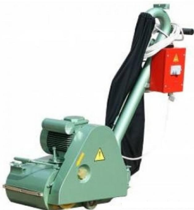
**Описание:** Циклевочная машина СО-206А (СО-206.1А) предназначена для обработки паркетных и дощатых полов, как вновь уложенных, так и отремонтированных; для снятия старых лакокрасочных покрытий и очистке от загрязнений при ремонте полов.
