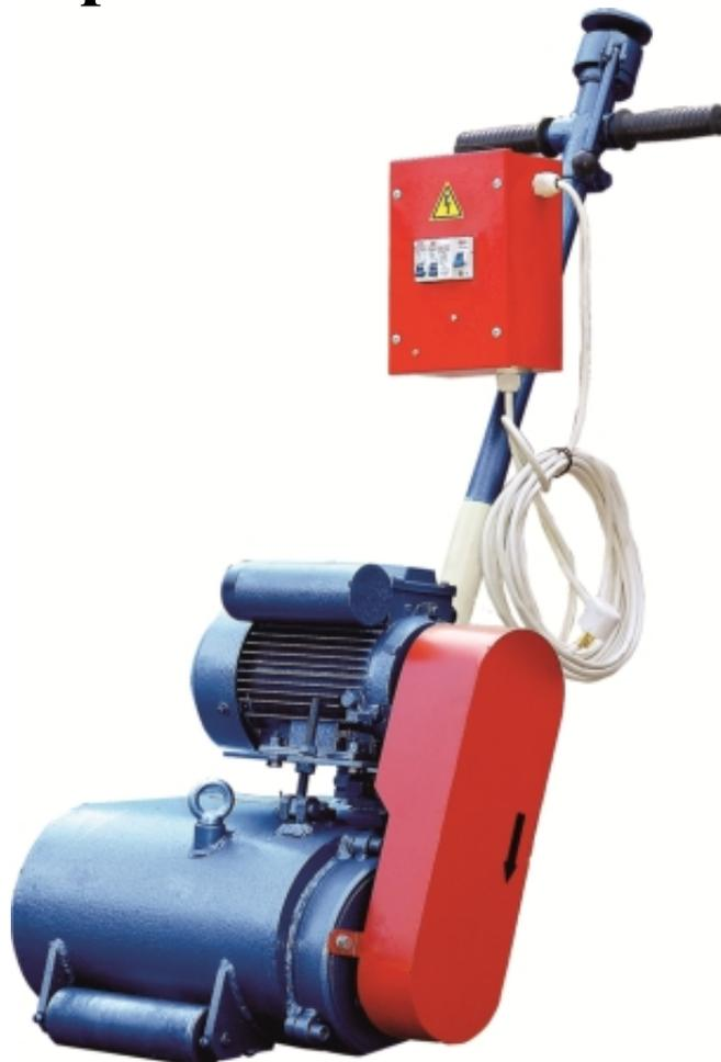
**Описание:** Машины предназначены для строжки деревянных и паркетных полов при строительстве и реконструкции зданий в промышленном, гражданском и жилищном строительстве.
