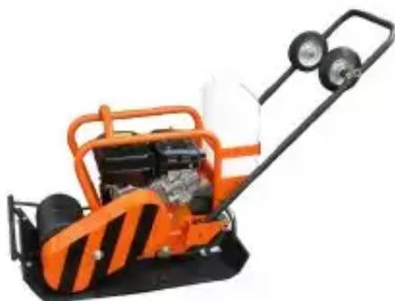
**Описание:** Виброплиты СО-310М, СО-330 с приводом от двигателя внутреннего сгорания предназначена для уплотнения разного рода грунтов (песок, щебень и т.п.), тротуарных плиток и дорожных покрытий (асфальтов, асфальто-бетонных и других бетонодержащих строительных смесей) методом поверхностной вибрации.
