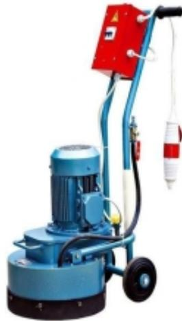
**Описание:** Машины мозаично-шлифовальные предназначена для оттирки, шлифования и полирования монолитных покрытий из обычного и декоративного бетона при строительстве и реконструкции зданий и сооружений в промышленном и гражданском строительстве. Основными рабочими инструментами машины являются фрезы алмазные. Возможна установка шести трехгранных сегментов
