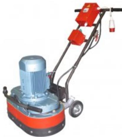
**Описание:** Машины мозаично-шлифовальные предназначена для оттирки, шлифования и полирования монолитных покрытий из обычного и декоративного бетона при строительстве и реконструкции зданий и сооружений в промышленном и гражданском строительстве. Основными рабочими инструментами машины являются фрезы алмазные. Возможна установка шести трехгранных сегментов
