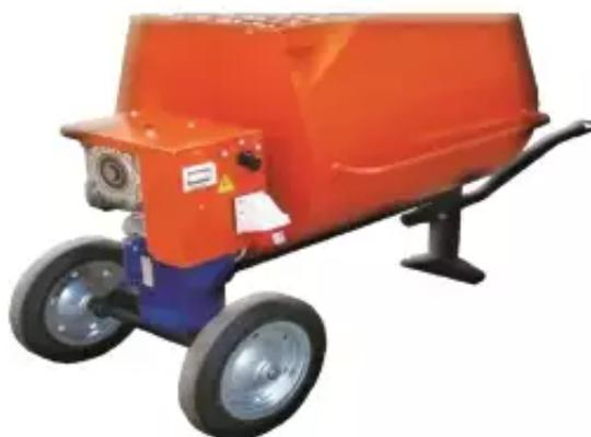
**Описание:** Растворосмеситель СО-351 передвижная машина для циклического приготовления строительных растворов принудительным перемешиванием. Принцип работы растворосмесителя заключается в перемешивании исходных компонентов или готовых сухих смесей с водой, четырьмя резиновыми лопастями, закрепленными на горизонтальном валу внутри барабана.
